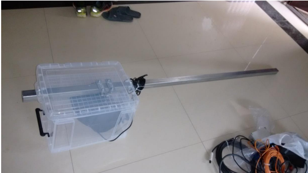
Abbildung 5: Die elek. Winde + die Befestigungs- und Schutzvorrichtung (eigenes Foto)
